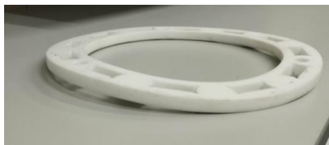
Supporte de amostras em Teflon depois de exposição com \text{CO}_2 s em 120°C
